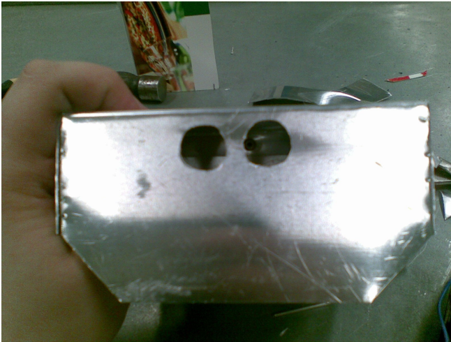
Kuva9. SRF08 varten tehdyt reiät.
